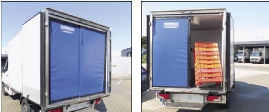
2 gleich große Isolations-Segmente querverschiebbar,
