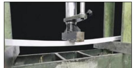
Belastungstest GFK Rohr
