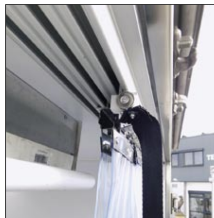
Aluminium schuifrails met 3 kanalen
